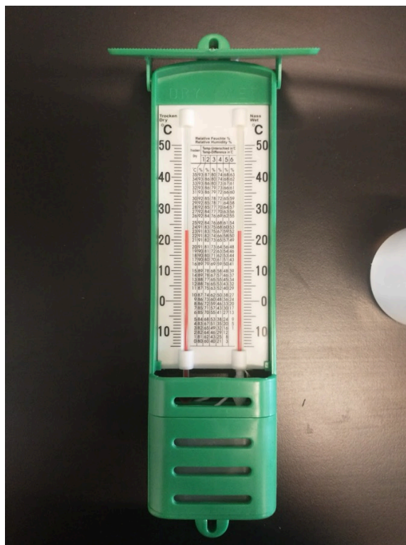
Figur 1: Psykromeret. Tørtermometeret sidder til venstre, vådtermometeret til højre. Tabellen i midten giver den relative luftfugtighed: gå ind i rækken med tørtemperaturen og kolonnen med temperaturforskellen.
